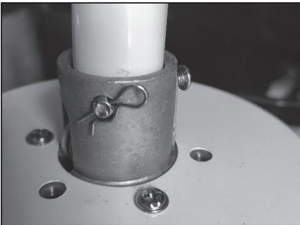
g. Considere que una vez colocada la chaveta, la misma debe quedar pegada al barral y luego se deben ajustar los tornillos. Note que la chaveta debe quedar en la posición de la imagen.
